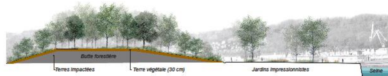
Coupe de principe de constitution de la butte
